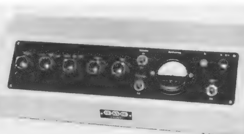
Bild 5. Steuerverstärker von Tekade mit Transistorbestückung
